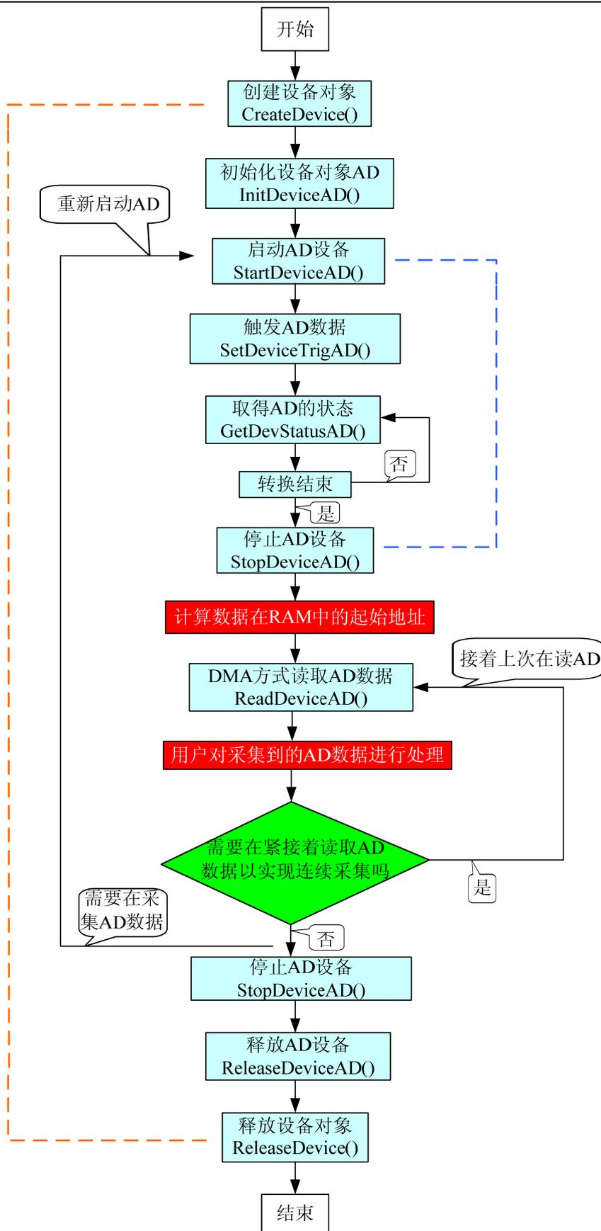
图 2.1.2 DMA 方式 AD 采集实现过程
