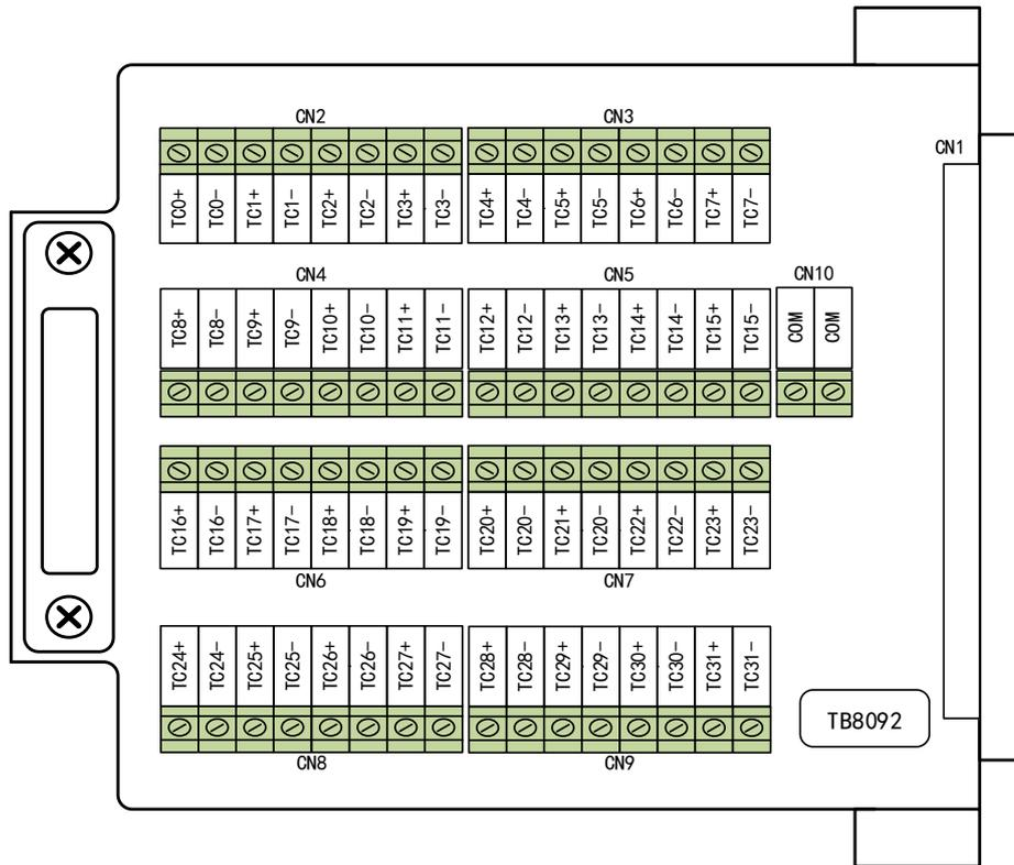
图 3-2-2 TB8092 端子引脚定义
